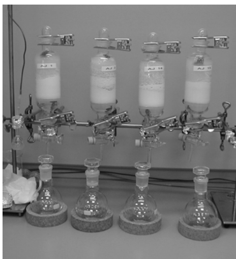
Extraktion der Probennahmesäulen
