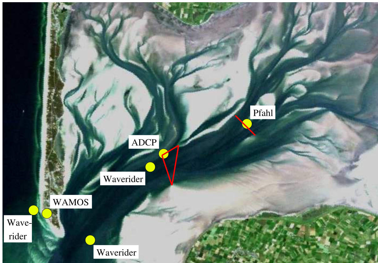
Abbildung 5: Lage der statischen Messplattformen. Entlang den roten Linien wurden im Frühjahr 2004 Kalibrierfahrten mit FS Ludwig Prandtl durchgeführt. Waverider-Bojen lagen nahe dem Boden-ADCP in 2002 und 2003, östlich Hörnum Odde in 2004 und 2005 und westlich von WAMOS in 2003, 2004 und 2005.
