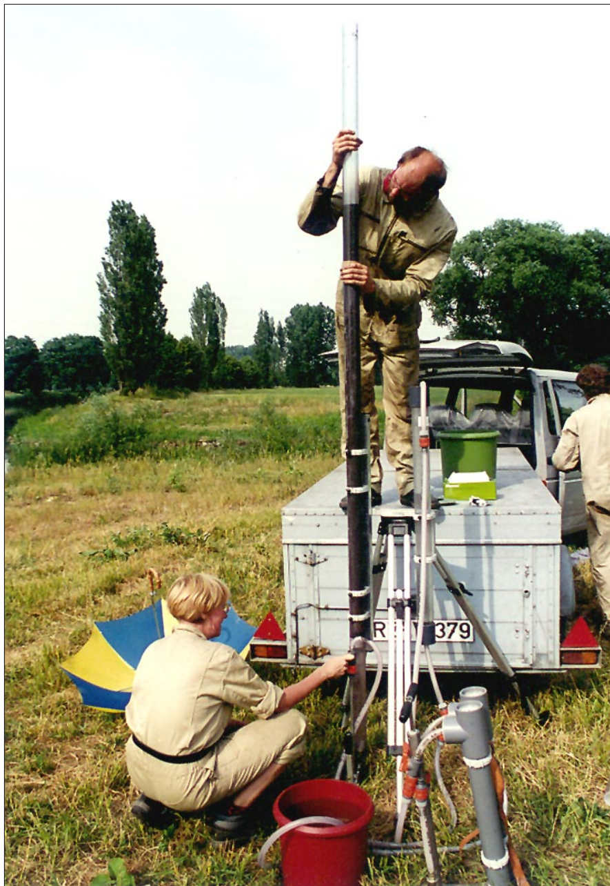
Abb. 4.2: Überführung der Unterwassersedimentkerne in Transportbehältnisse mit Hilfe des Probenentfernungs- und Aufteilungssets
