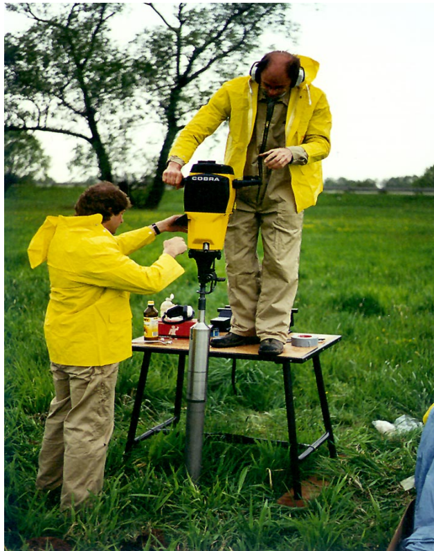
Abb. 4.2: Probenahme von Auenkernen mit dem Stechrohr-Bohrgerät nach Merkt und Streif bei Hradec Králové
